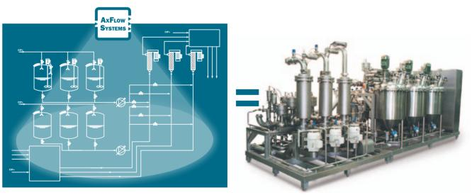
Unidades de mezcla de colores diseñadas y construidas especialmente para la dosificación en línea y la mezcla de colores y sabores en pasta de dientes. El sistema incorpora preparación de colores a partir de pigmentos en polvo. La unidad es extremadamente estable y precisa con un margen del < 0,2%. También facilita rutinas CIP y SIP completas e incluye control y comunicación con el sistema SCADA del emplazamiento.
