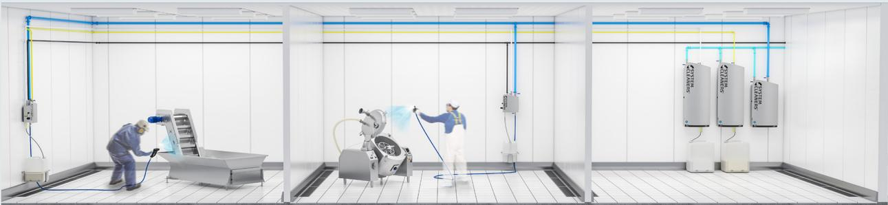
Eine Hybridlösung hat den gleichen Aufbau wie ein zentrales System, aber mit der Möglichkeit, ein zusätzliches Produkt an allen oder einigen Arbeitsstationen ein zusätzliches Produkt hinzuzufügen. Diese Lösung wird häufig eingesetzt, wenn eine zusätzliche Reinigungsaufgabe unabhängig vom regulären Reinigungsprogramm durchgeführt werden soll.
