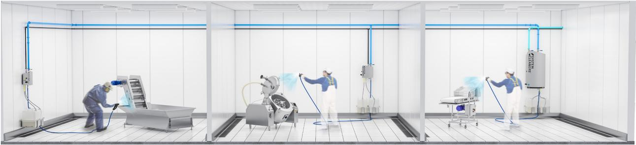
Bei einer dezentralen Lösung werden die konzentrierten Chemikalien an jeder Arbeitsstation gelagert und abgegeben. Dies kann eine Hauptstation oder ein Satellit sein.
