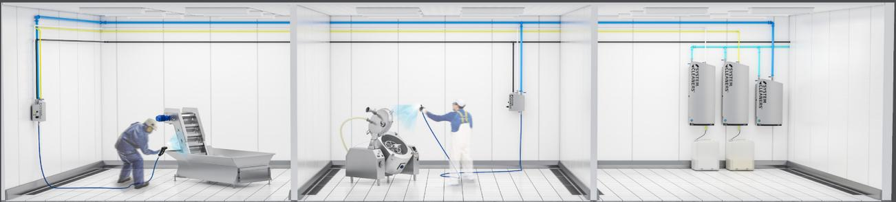
Eine zentrale Lösung zeichnet sich dadurch aus, dass vorverdünnte Chemikalien von einer an einem separaten, zentralen Ort platzierten Chemikalienpumpstation zu jeder Arbeitsstation gepumpt werden. Es minimiert den täglichen Umgang mit Chemikalien, gewährleistet eine einheitliche Konzentration für alle Nutzer/Arbeitsstationen und macht die Bedienung des Systems so einfach und sicher wie möglich.
