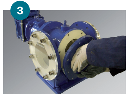
3 Große Zugangsabdeckung abnehmen, für eine Sichtprüfung der Messer
