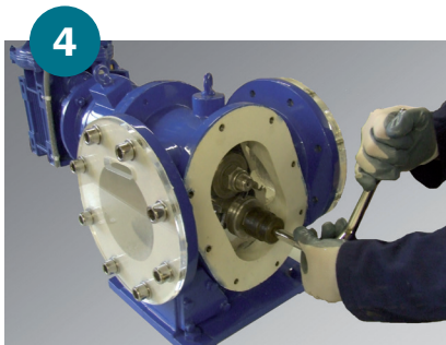
4 Wellenmuttern lösen und entfernen
