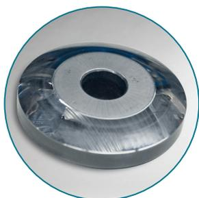
Ventilsitz – Erosion durch hohen Druck und Partikel im geförderten Medium. Führt zu Leckagen.
