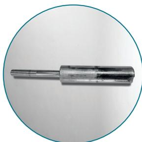
Durch Kavitation im System abgenutzter Kolben.
