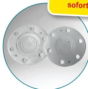
Durch Undichtigkeit am Auslassventil beschädigte Membranen.
