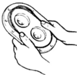
Abb.100 Montage des Deckels
