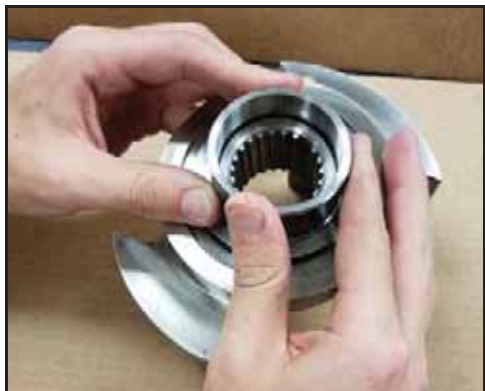
Figure 172 – Enfoncement du manchon en position
