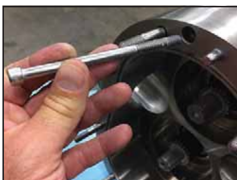
Figure 129 – Installation des vis de fixation du corps de la pompe
