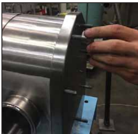
Figure 187 – Installation des écrous du couvercle
