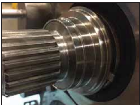
Figure 102 – Bague de réglage installée
