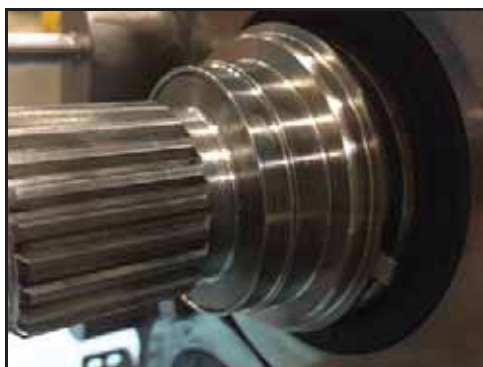
Figure 122 – Bague de réglage installée
