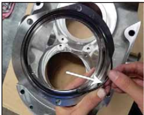
Figure 109 – Installation du joint torique du logement de garniture
