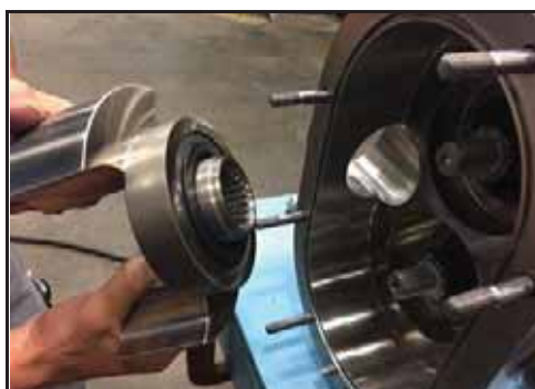
Figure 177 – Enfoncement du rotor sur l'arbre
