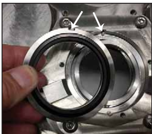
Figure 94 – Installation de la garniture fixe côté rinçage
