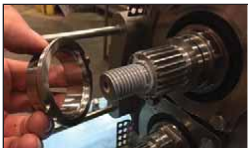
Figure 121 – Installation de la bague de réglage
