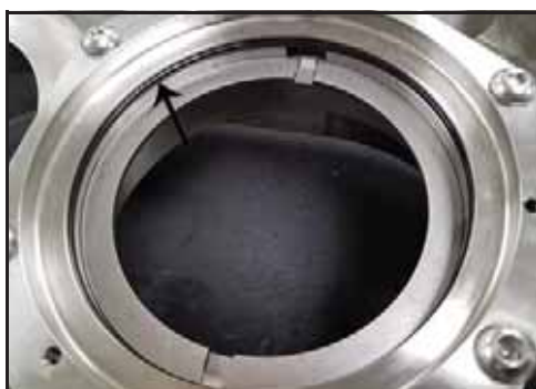
Figure 114 – Emplacement du joint torique de la garniture
