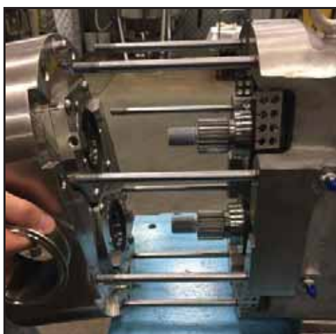
Figure 127 – Installation du corps de la pompe
