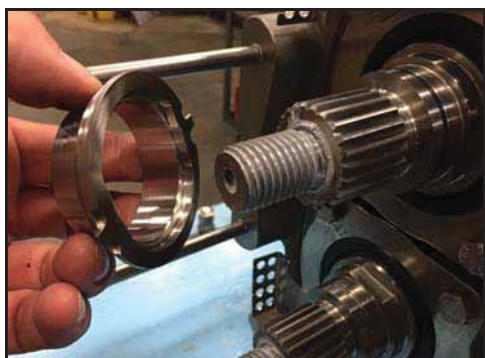
Figure 101 – Installation de la bague de réglage
