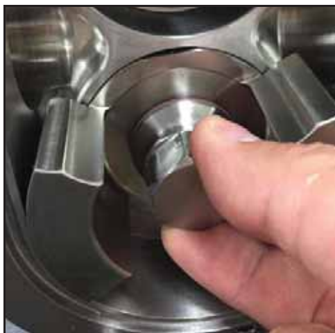
Figure 181 – Installation de l'écrou de rotor
