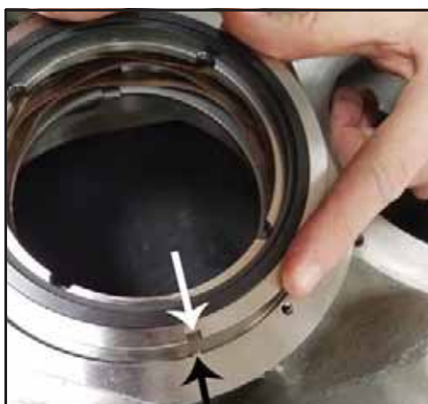
Figure 116 – Installation de la garniture fixe côté rinçage
