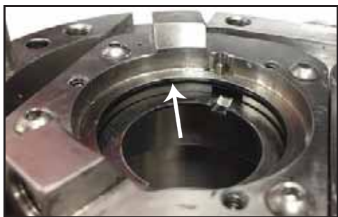
Figure 91 – Emplacement du joint torique de la garniture
