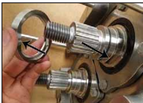
Figure 162 – Installation du siège de la garniture
