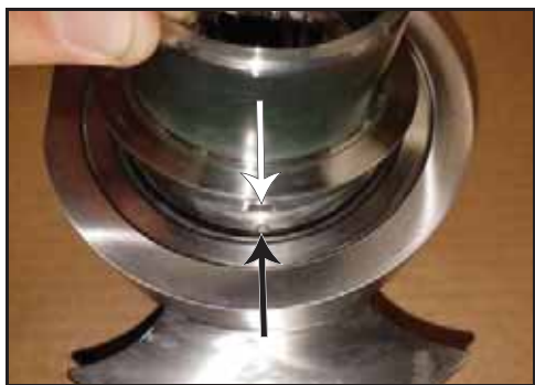
Figure 171 – Alignement de l'encoche et de la goupille
