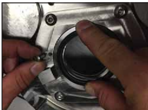
Figure 96 – Installation des boulons de fixation de la garniture
