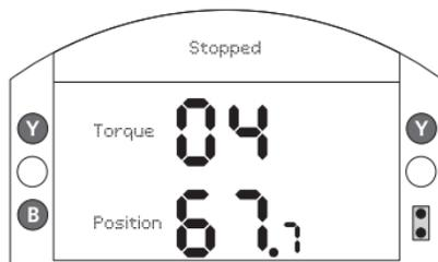
Fig. 4.4.3 Torque (D) + Position
