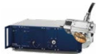
El análisis de los procesos con espectrómetro de infrarrojo cercano (NIR) permite conocer muchos parámetros relevantes de la calidad en una sola medición y, como mide muchas muestras en menos tiempo, ayuda al fabricante a evaluar la calidad de los productos a lo largo de la cadena de producción, desde la inspección de las materias primas producto intermedio y producto finalizado.
