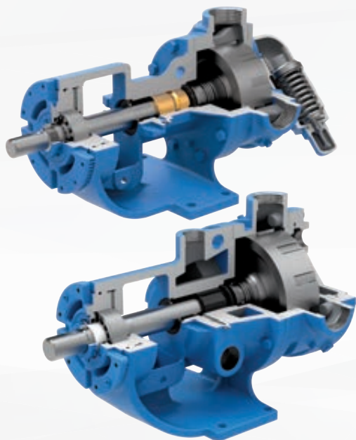
4124B (no encamisado, sello detrás del rotor)
