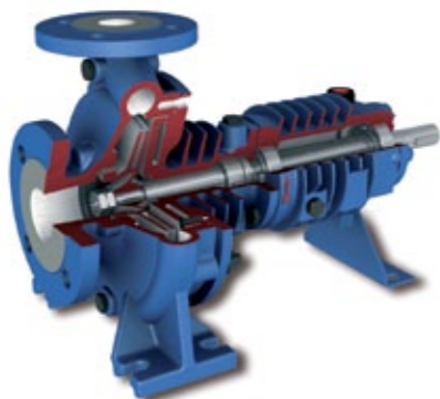
TCD - KONSTRUKCE PRO TEPLOSMĚNNÉ OLEJE DO 320 °C S JEDNODUCHÝMI MECHANICKÝMI UCPÁVKAMI BEZ NUTNOSTI CHLAZENÍ ODVOZENÉ OD DIN 24258 NORMY CHEMICKÝCH ČERPADEL; LOŽISKA JSOU MAZÁNA LOŽISKOVÝM OLEJEM A NIKOLI ČERPANOU KAPALINOU JAKO U KONKURENČNÍCH VÝROBKŮ.
