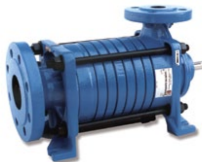
TBA - KONSTRUKCE SAMONASÁVACÍHO VYSOKOTLAKÉHO ČERPADLA S VELMI NÍZKÝM NPSHR SCHOPNÁ ČERPAT KAPALINY NA MEZI VARU S MINIMALIZACÍ RIZIKA KAVITACE; KOMPAKTNÍ LOŽISKOVÝ ŠTÍT, KRÁTKÁ HŘÍDEL A TÍM KOMPAKTNÍ ROZMĚRY VYLUCUJÍ VIBRACE, COŽ PRODLUŽUJE ŽIVOTNOST LOŽISEK A UCPÁVKY.
